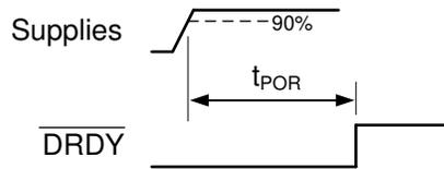
**Figure 6-3. Power-On-Reset Timing**
