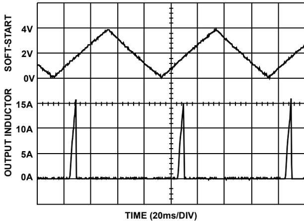
FIGURE 4. OVER-CURRENT OPERATION
