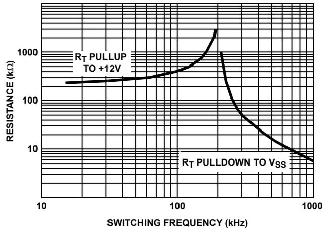
FIGURE 1. R<sub>T</sub> RESISTANCE vs FREQUENCY
