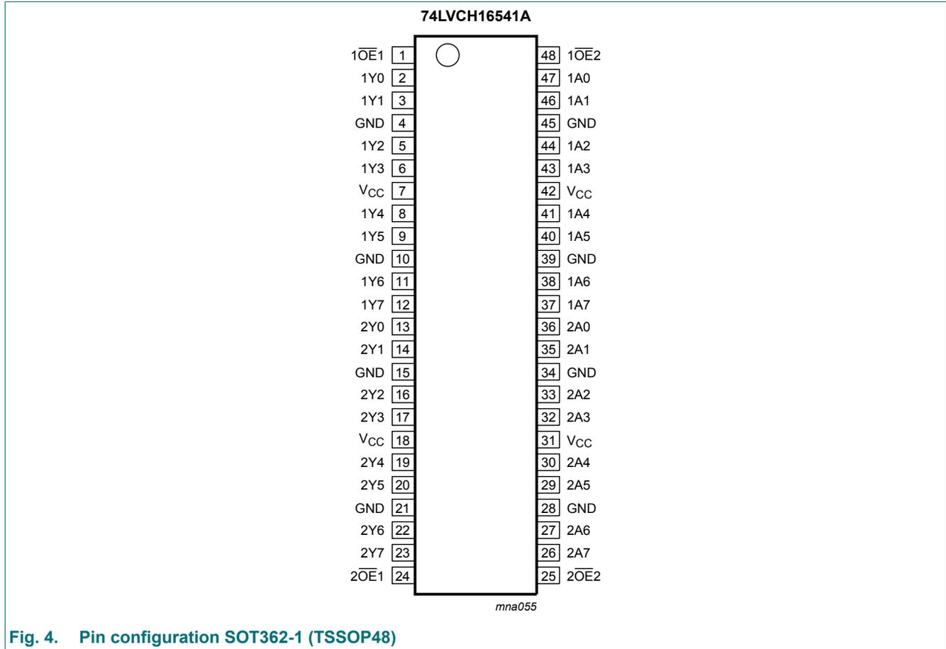
Fig. 4. Pin configuration SOT362-1 (TSSOP48)
