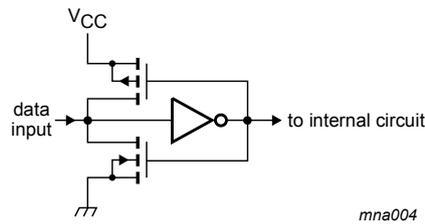
Fig. 3. Bus hold circuit
