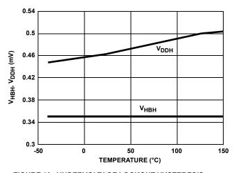
FIGURE 10. UNDERVOLTAGE LOCKOUT HYSTERESIS vs TEMPERATURE
