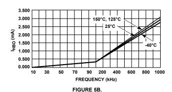
FIGURE 5. OPERATING CURRENT vs FREQUENCY
