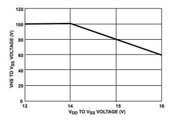
FIGURE 16. VHS VOLTAGE vs  $V_{\mbox{\scriptsize DD}}$  VOLTAGE
