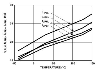
FIGURE 11. PROPAGATION DELAYS vs TEMPERATURE
