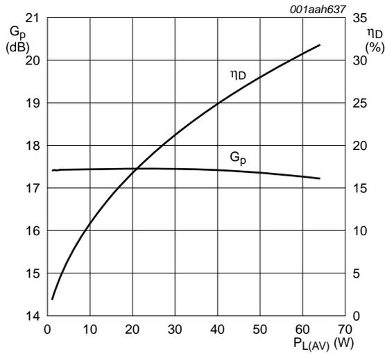
$V_{DS} = 32\text{ V}$ ;  $I_{Dq} = 1600\text{ mA}$ ;  $f_1 = 2157.5\text{ MHz}$ ;  $f_2 = 2167.5\text{ MHz}$ ; carrier spacing 10 MHz.
