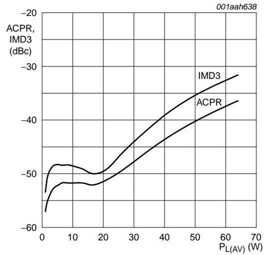
$V_{DS} = 32\text{ V}$ ;  $I_{Dq} = 1600\text{ mA}$ ;  $f_1 = 2157.5\text{ MHz}$ ;  $f_2 = 2167.5\text{ MHz}$ ; carrier spacing 10 MHz.
