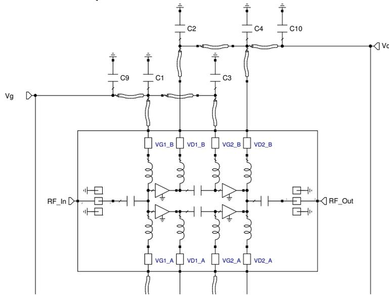
Overall die size 4780 x 3610 (+0/-50) microns, die thickness 100 (+/-10) micron.
