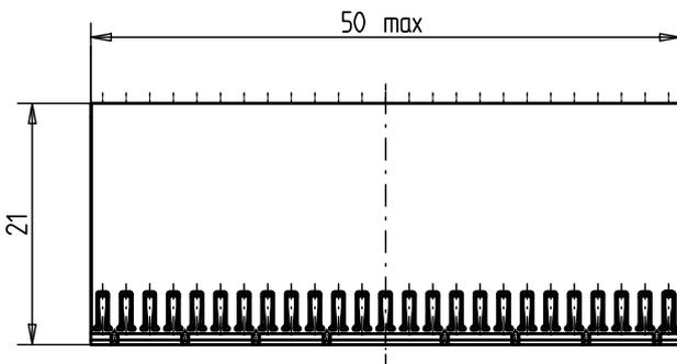
EE-Zone für durchkontaktierte Löcher  $\varnothing 0.6 \pm 0.05$
