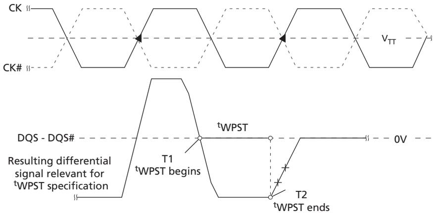
**Figure 82: WRITE Burst**
