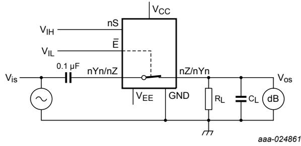
$V_{CC} = 4.5\text{ V}$ ;  $GND = 0\text{ V}$ ;  $V_{EE} = -4.5\text{ V}$ ;  $R_L = 50\ \Omega$ ;  $R_S = 1\text{ k}\Omega$ .
