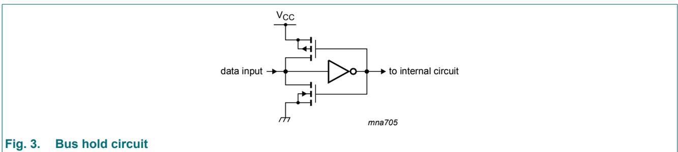
Fig. 3. Bus hold circuit
