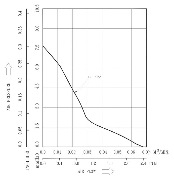
\* TEST CONDITION: INPUT VOLTAGE — OPERATION VOLTAGE TEMPERATURE — ROOM TEMPERATURE HUMIDITY — 65%RH
