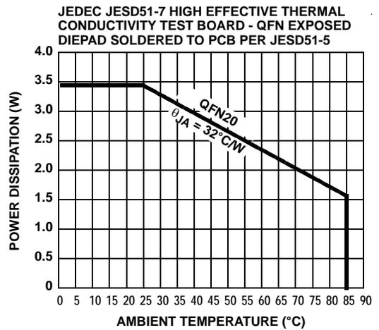
FIGURE 12. PACKAGE POWER DISSIPATION vs AMBIENT TEMPERATURE
