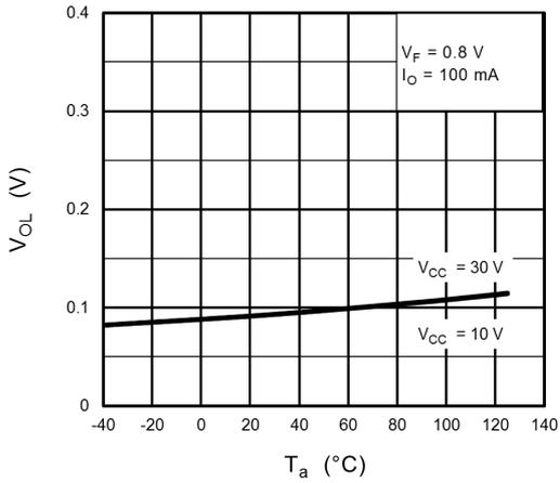
Fig. 13.2.7  $V_{OL} - T_a$
