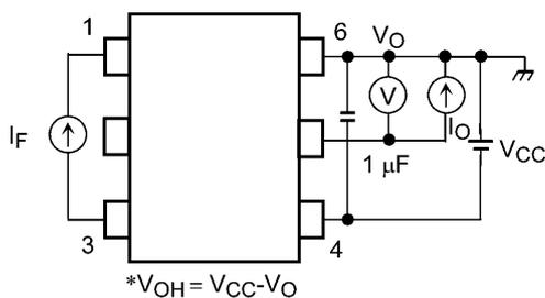
\* $V_{OH} = V_{CC} - V_O$
