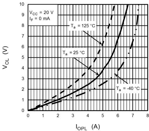
Fig. 13.2.9  $V_{OL} - I_{OPL}$
