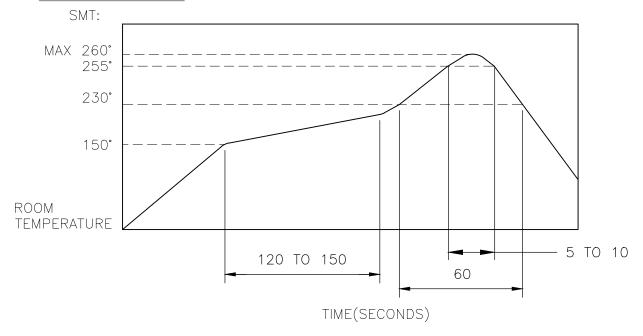
THE CONDITION NOTED ABOVE IS THE TEMPERATURE OF THE COPPER FOIL ON THE SURFACE OF THE PCB. THERE ARE CASES WHERE THE TEMPERATURE OF THE BOARD GREATLY DIFFERS FROM THE SURFACE OF THE SWITCH. DO NOT ALLOW THE SURFACE
