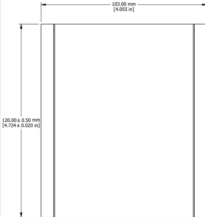
EXTRUSION DESIGNED FOR 100MM WIDE PC BOARD
