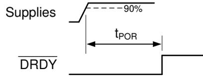
**Figure 6-3. Power-On-Reset Timing**
