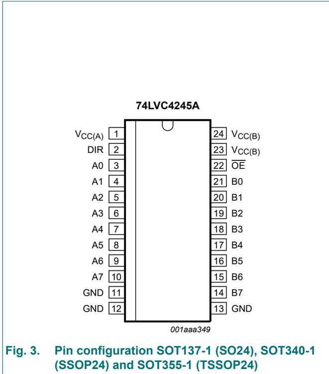
Fig. 3. Pin configuration SOT137-1 (SO24), SOT340-1 (SSOP24) and SOT355-1 (TSSOP24)
