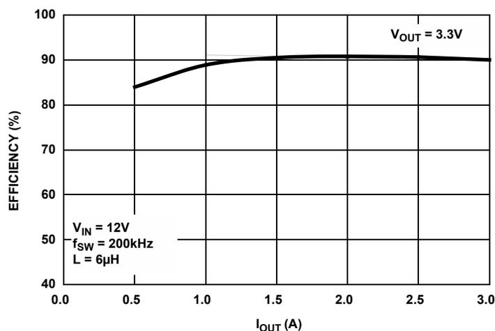
FIGURE 1. ZL2103 EFFICIENCY
