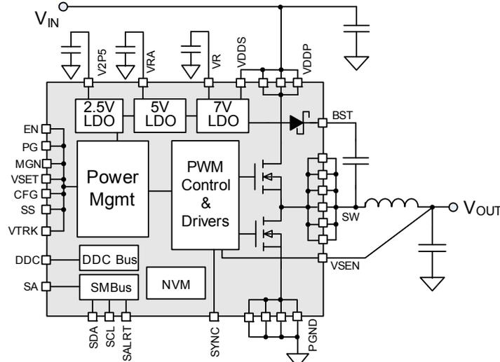
**FIGURE 3. BLOCK DIAGRAM**
