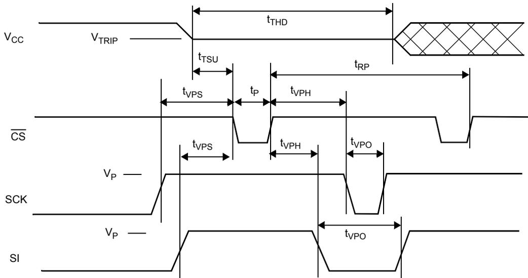
**$V_{TRIP}$  Reset Conditions**
