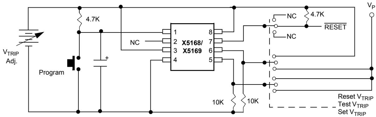
FIGURE 4. SAMPLE V<sub>TRIP</sub> RESET CIRCUIT
