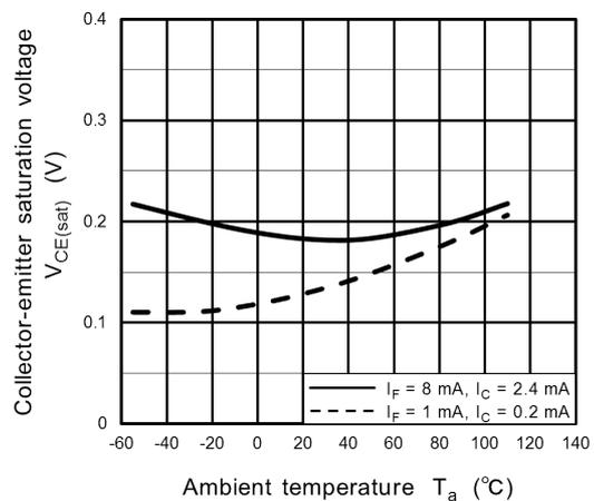
Fig. 11.10  $V_{CE(sat)} - T_a$
