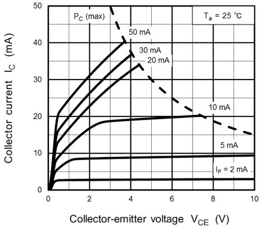
Fig. 11.7  $I_C - V_{CE}$
