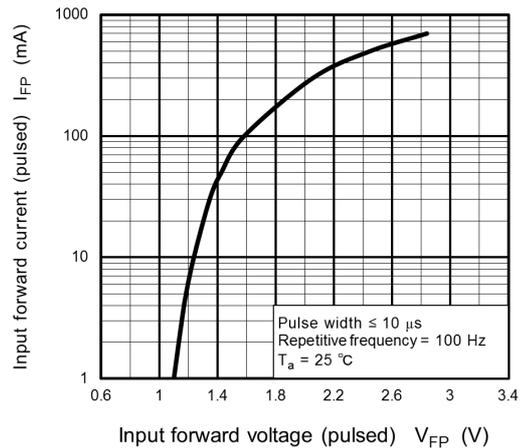
Fig. 11.6  $I_{FP} - V_{FFP}$
