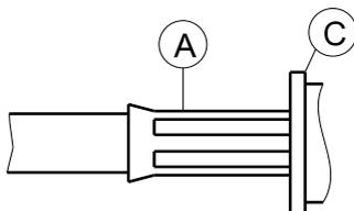
Hülse A über Abschirmung schieben und möglichst nahe am Gehäuse C klemmen.
