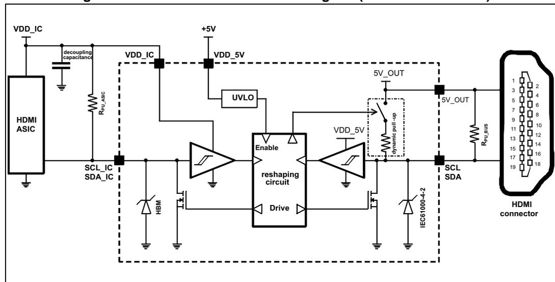
The [Figure 5](#) illustrates the electrical parameters of the DDC block specified in [Table 8](#).
