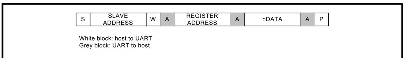
**FIGURE 5. MASTER READS FROM SLAVE (XR20M1280)**
