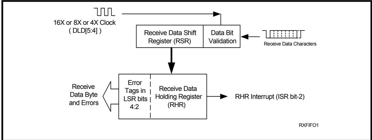
FIGURE 17. RECEIVER OPERATION IN FIFO AND AUTO RTS FLOW CONTROL MODE
