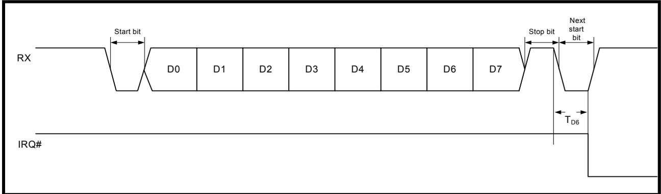
FIGURE 27. RECEIVE INTERRUPT CLEAR
