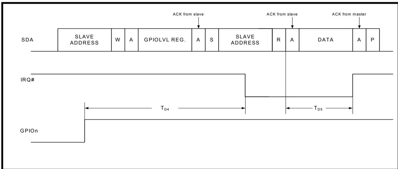
FIGURE 26. RECEIVE INTERRUPT
