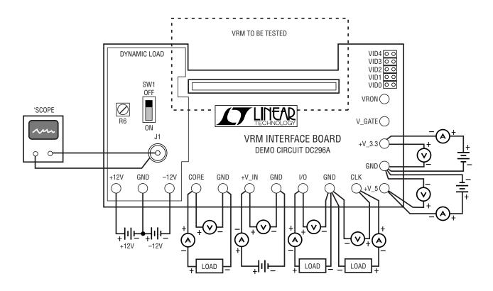
Figure 1. DC296A Hookup Diagram
