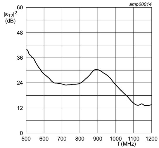
$T_{case} = 25\text{ }^\circ\text{C}$ ;  $V_{DS} = 28\text{ V}$ ;  $I_{Dq1} = 40\text{ mA}$ ;  $I_{Dq2} = 260\text{ mA}$ ,
