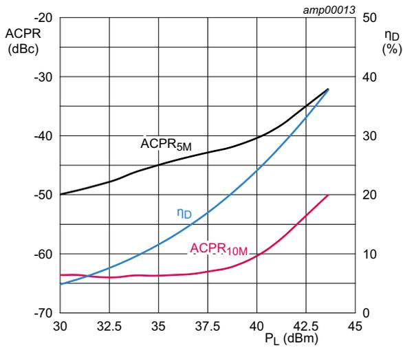
$T_{case} = 25\text{ }^\circ\text{C}$ ;  $V_{DS} = 28\text{ V}$ ;  $I_{Dq1} = 60\text{ mA}$ ;  $I_{Dq2} = 240\text{ mA}$ ;
