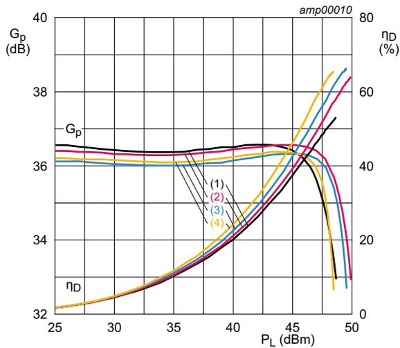
$T_{case} = 25\text{ }^{\circ}\text{C}$ ;  $V_{DS} = 28\text{ V}$ ;  $I_{Dq1} = 60\text{ mA}$ ;  $I_{Dq2} = 240\text{ mA}$ . Per section.
