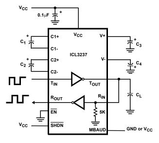
FIGURE 5. TRANSMITTER LOOPBACK TEST CIRCUIT
