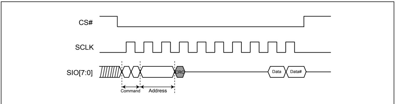
**Figure 126. CRC Timing (RDPASS)**
