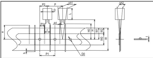
■ 2.0mm(φ5) or 3.5mm(φ8) or 5.0mm(φ10) pitch taping
