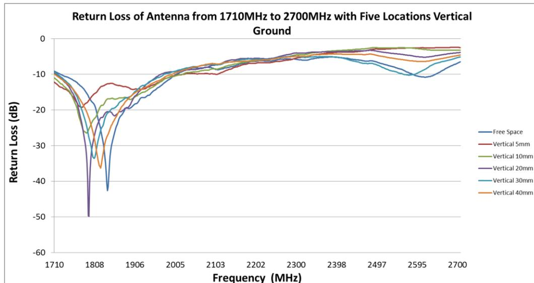
**FIGURE 6.2.3 RETURN LOSS OF ANTENNA FROM 1710MHZ TO 2700MHZ WITH FIVE LOCATIONS VERTICAL GROUND**
