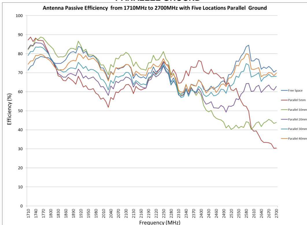
**FIGURE 6.1.5 EFFICIENCY OF ANTENNA FROM 1710MHZ TO 2700MHZ WITH FIVE LOCATIONS PARALLEL GROUND**
