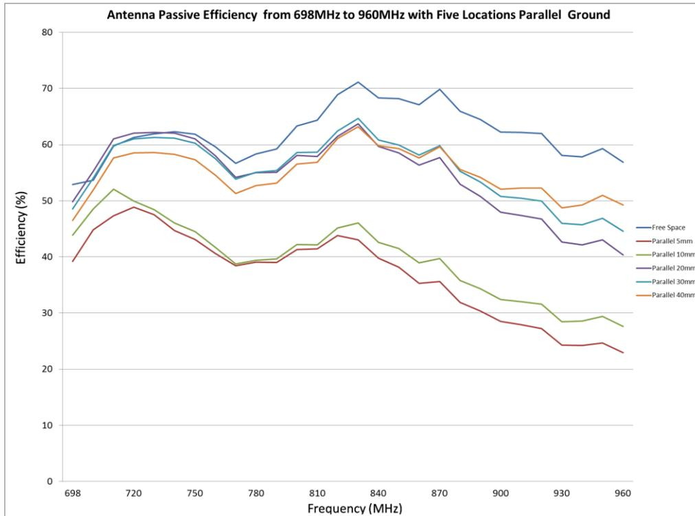
**FIGURE 6.1.4 EFFICIENCY OF ANTENNA FROM 698MHZ TO 960MHZ WITH FIVE LOCATIONS PARALLEL GROUND**
