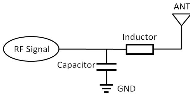
FIGURE 5.2 CONFIG 1 FOR HIGH BAND
