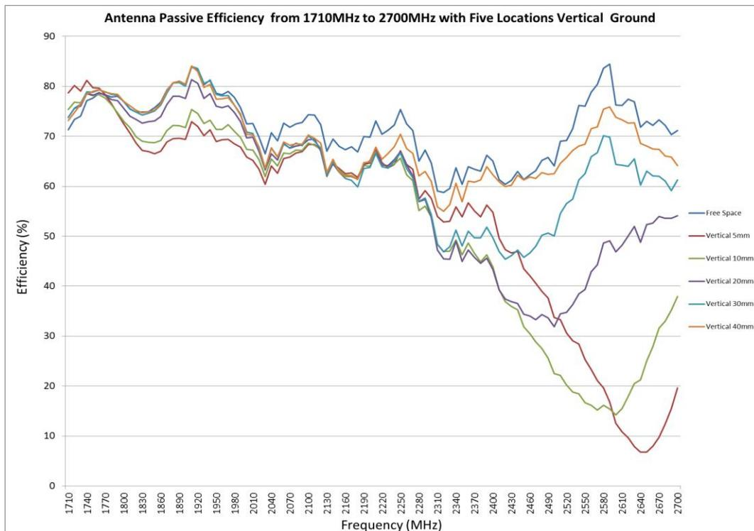
**FIGURE 6.2.5 EFFICIENCY OF ANTENNA FROM 1710MHZ TO 2700MHZ WITH FIVE LOCATIONS VERTICAL GROUND**
