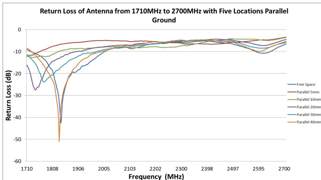
**FIGURE 6.1.3 RETURN LOSS OF ANTENNA FROM 1710MHZ TO 2700MHZ WITH FIVE LOCATIONS PARALLEL GROUND**
