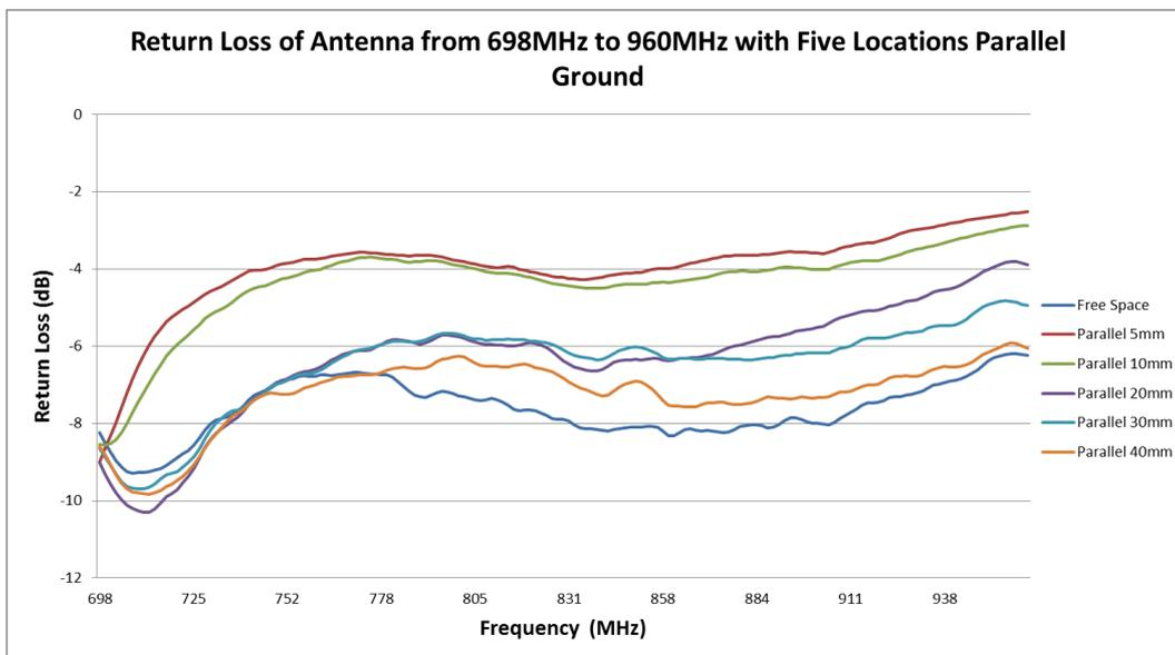
**FIGURE 6.1.2 RETURN LOSS OF ANTENNA FROM 698MHZ TO 960MHZ WITH FIVE LOCATIONS PARALLEL GROUND**
