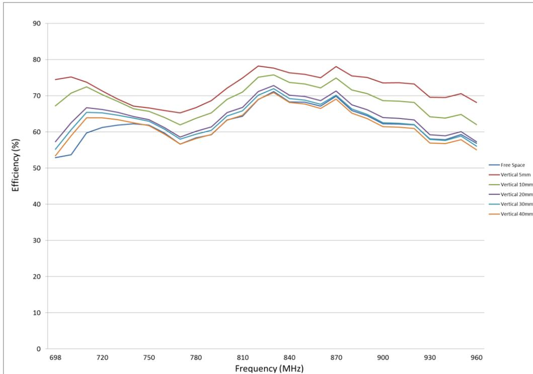
**FIGURE 6.2.4 EFFICIENCY OF ANTENNA FROM 698MHZ TO 960MHZ WITH FIVE LOCATIONS VERTICAL GROUND**
