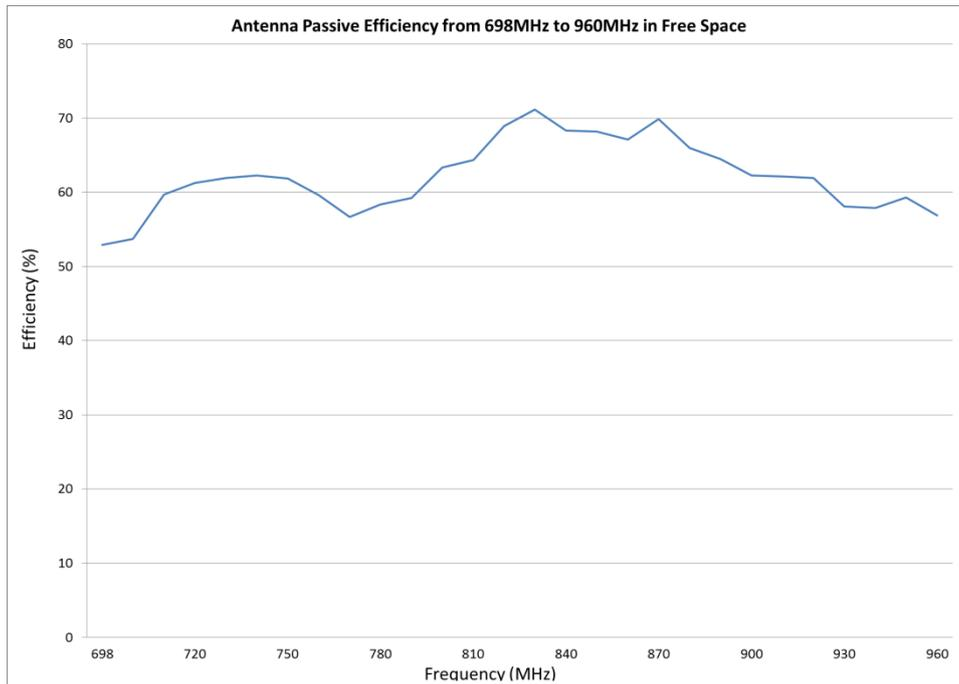
**FIGURE 4.4.1 ANTENNA PASSIVE EFFICIENCY FROM 698MHZ TO 960MHZ IN FREE SPACE**
