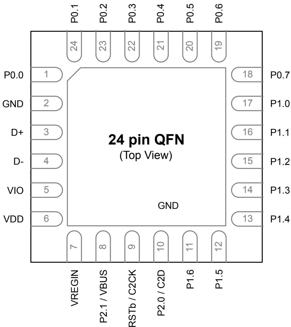
Figure 6.2. EFM8UB3x-QFN24 Pinout
