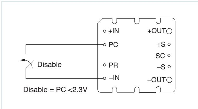
Figure 2 — Module enable/disable
