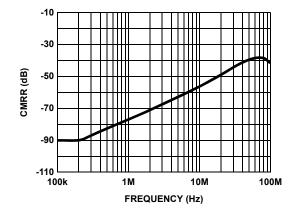
FIGURE 9. COMMON-MODE REJECTION RATIO vs FREQUENCY
