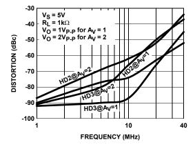
FIGURE 16. HARMONIC DISTORTION vs FREQUENCY
