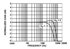
FIGURE 33. VIDEO LINE DRIVER FREQUENCY RESPONSE
