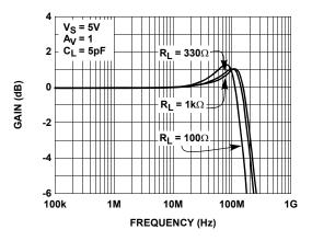
FIGURE 2. SMALL SIGNAL FREQUENCY RESPONSE FOR VARIOUS  $R_{\mathsf{LOAD}}$
