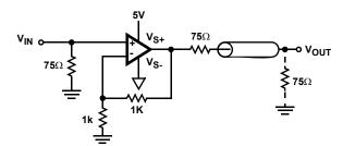
FIGURE 27. SYNC PULSE REMOVER
