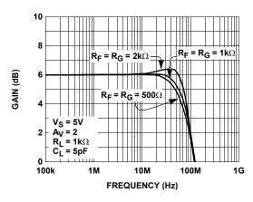
FIGURE 7. SMALL SIGNAL FREQUENCY RESPONSE FOR VARIOUS  $\rm R_{\rm F}$  AND  $\rm R_{\rm G}$
