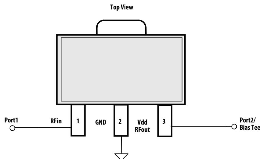
**Figure 32. S-parameter and Noise parameter test circuit**
