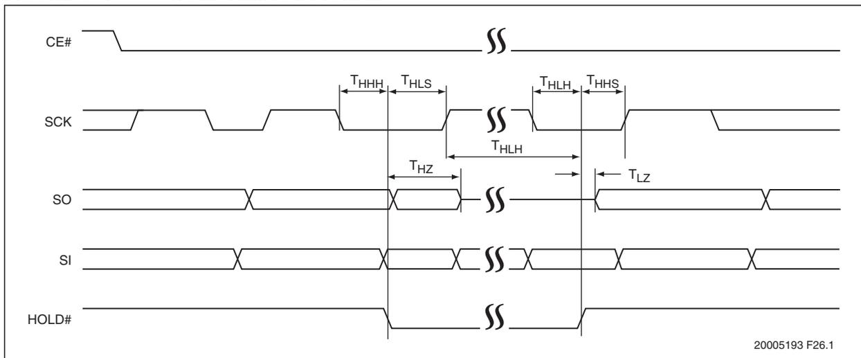
**FIGURE 6-6: STATUS REGISTER WRITE TIMING**
