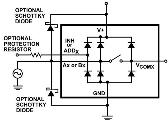
**FIGURE 7. OVERVOLTAGE PROTECTION**
