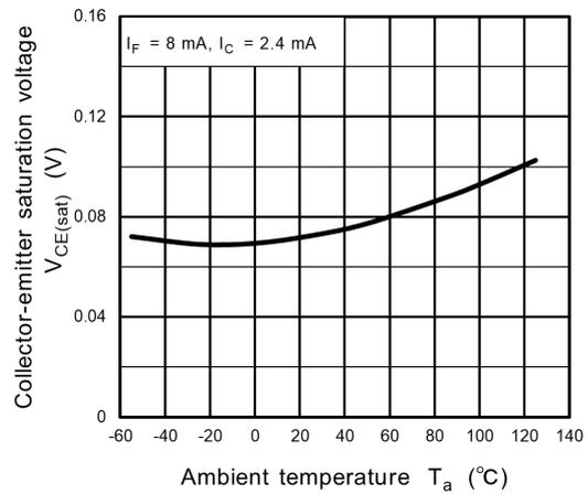
**Fig. 12.10**  $V_{CE(sat)} - T_a$
