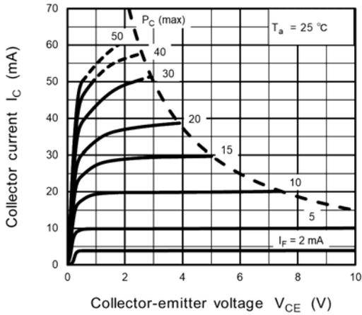
**Fig. 12.7**  $I_C - V_{CE}$
