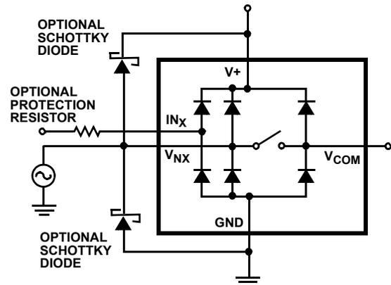
FIGURE 6. OVERVOLTAGE PROTECTION
