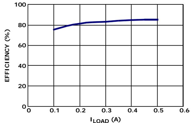
FIGURE 3. SYSTEM EFFICIENCY (BOOST + LDO) FOR 12V<sub>IN</sub> TO 13.3V<sub>OUT</sub>
