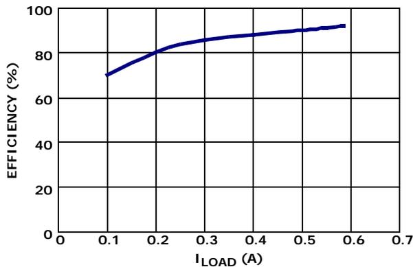
FIGURE 2. BOOST EFFICIENCY FOR 12V<sub>IN</sub> TO 14.3V<sub>OUT</sub>
