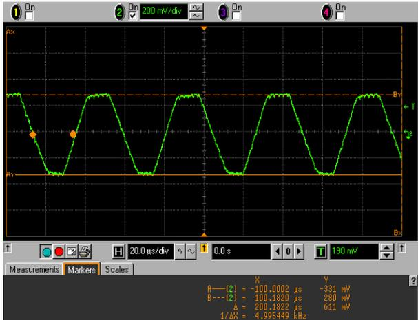
FIGURE 12. 22kHz TONE ON 13.3V<sub>OUT</sub> WITH 500mA LOAD
