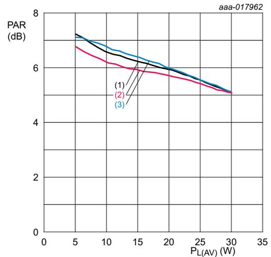
$V_{DS} = 28\text{ V}$ ;  $I_{Dq} = 300\text{ mA}$  (main device);
