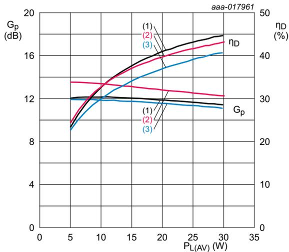
$V_{DS} = 28\text{ V}$ ;  $I_{Dq} = 300\text{ mA}$  (main device);
