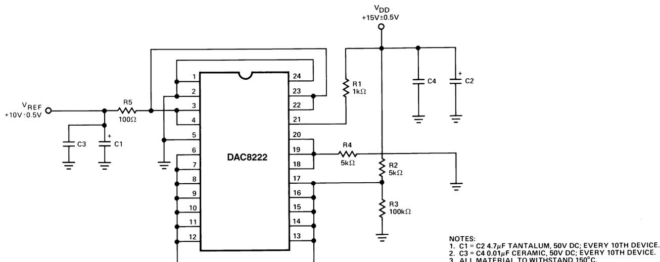
Figure 18. Burn-In Circuit
