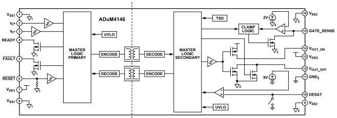
1 GROUNDS ON THE PRIMARY SIDE ARE ISOLATED FROM GROUNDS ON THE SECONDARY SIDE. 2GROUNDS ON THE SECONDARY SIDE ARE ISOLATED FROM GROUNDS ON THE PRIMARY SIDE.
