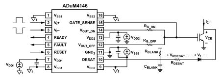
$^1\mathrm{GROUNDS}$  ON THE PRIMARY SIDE ARE ISOLATED FROM GROUNDS ON THE SECONDARY SIDE.  $^2\mathrm{GROUNDS}$  ON THE SECONDARY SIDE ARE ISOLATED FROM GROUNDS ON THE PRIMARY SIDE.
