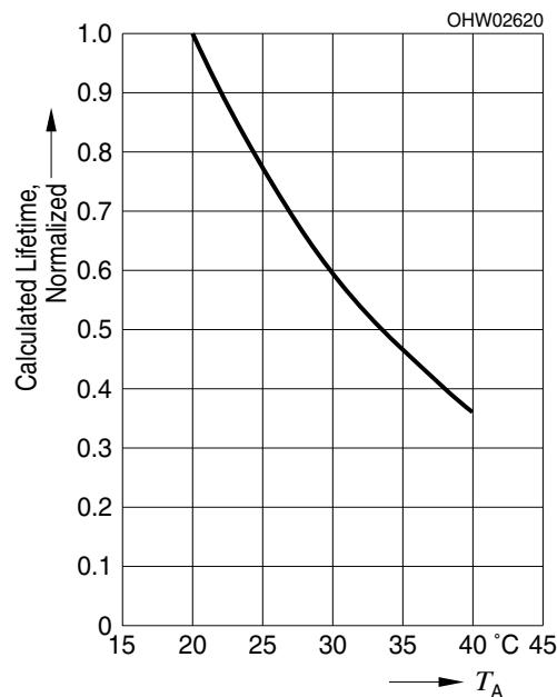
Das Diagramm zeigt die berechnete Lebensdauer in Abhangigkeit von Umgebungstemperatur, wobei ein abgeschatzter Wert fur die Aktivierungsenergie angenommen wird. Das Diagramm stellt eine Abschatzung fur die Lebensdauer dar und darf nicht als zugesicherte Eigenschaft verstanden werden.
