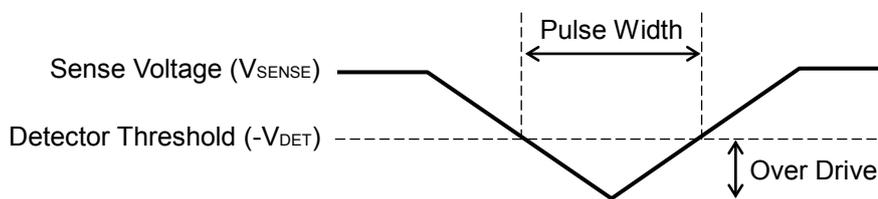
**V<sub>SENSE</sub> Input Waveform**
