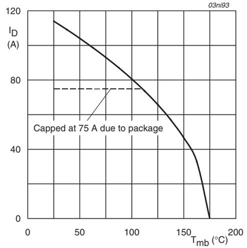
$$V_{GS} \geq 10V$$
