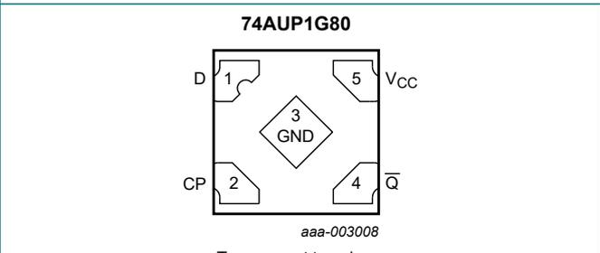
Fig. 7. Pin configuration SOT1226-3 (X2SON5)
