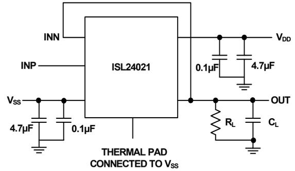
FIGURE 22. TEST CIRCUIT
