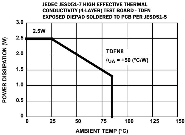
FIGURE 28. PACKAGE POWER DISSIPATION vs AMBIENT TEMPERATURE
