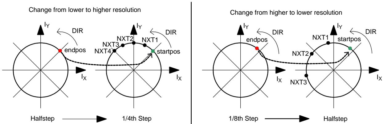
**Figure 10. NXT-Step-Mode Synchronization**
