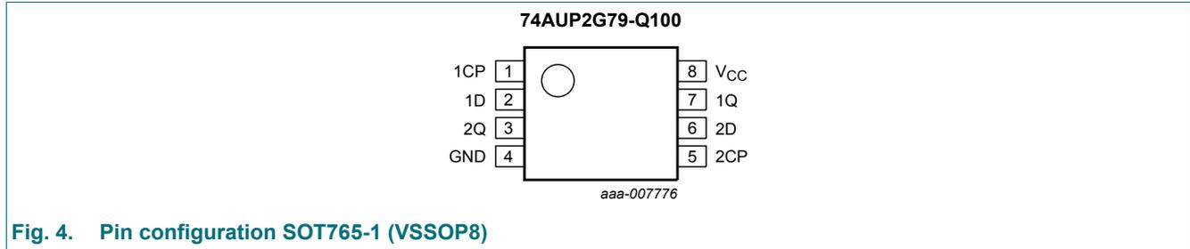
Fig. 4. Pin configuration SOT765-1 (VSSOP8)
