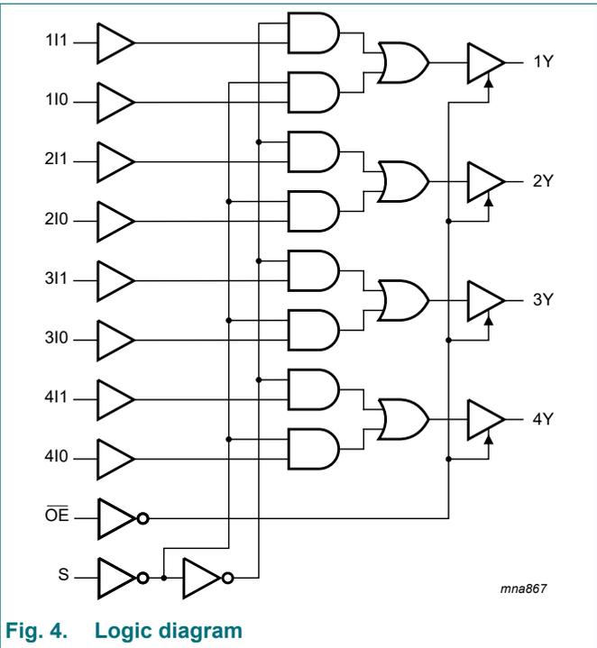
Fig. 4. Logic diagram
