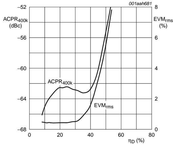
$V_{DS} = 28\text{ V}$ ;  $I_{Dq} = 550\text{ mA}$ ;  $f = 1990\text{ MHz}$ ;  $T_{case} = 25\text{ }^\circ\text{C}$ .
